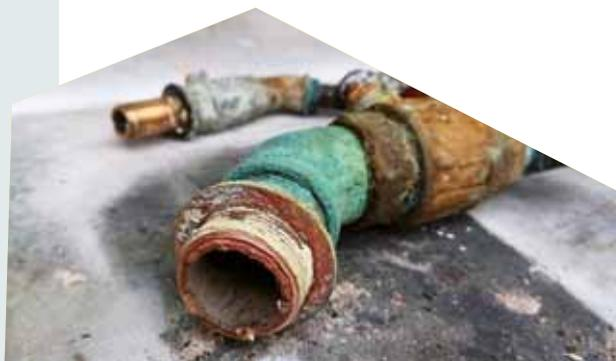
Sur un vieux bateau, il n'est souvent plus possible de savoir de quel matériau sont les passe-coques d'origine. Les alliages de laiton classiques peuvent se corroder au fil des ans, ou se casser dans le pire des cas. Veuillez toujours remplacer les vannes situées sous la ligne de flottaison par des vannes faites dans un
